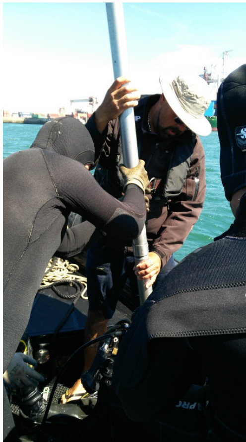
Fig. 8 – Aspecto da retirada do liner cheio de sedimento, do amostrador.
