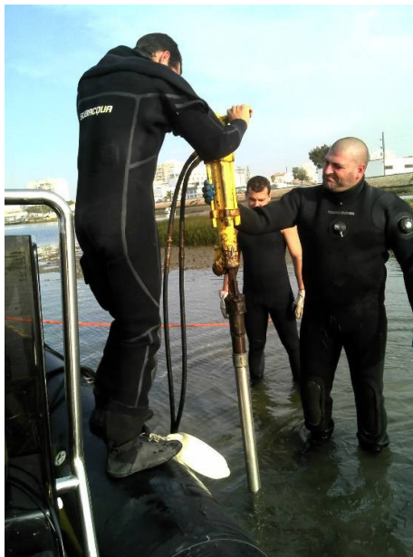
Fig. 3 – O mesmo amostrador vertical de sedimentos a ser usado num outro trabalho da GEOSUB (ao contrário do que se observa na imagem, no presente trabalho de Leixões todas as amostras foram colhidas por mergulhadores em imersão).
